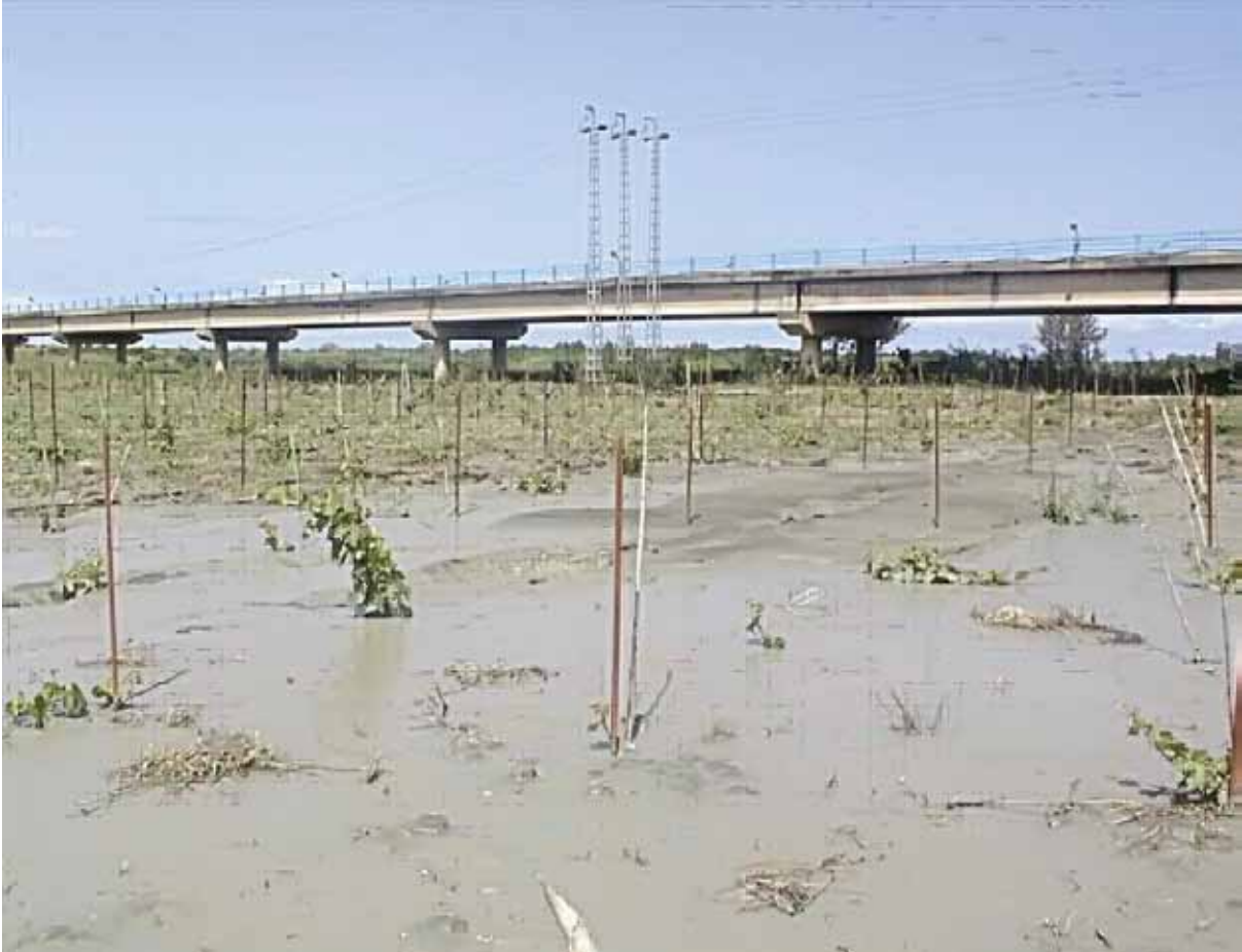
شكل 5.2. ظاهرة إسالة التربة التي نجمت عن الزلزال الذي ضرب مدينة بومرداس (الجزائر) بتاريخ 21/5/2003. [مصدر الصورة: اللعوامي، 2003].
