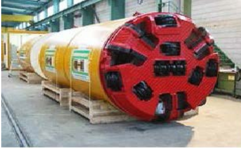
شكل (٥-١٧): رأس مزود بشفرات/ أقراص مع الشفط لحفر النفق الضيق
