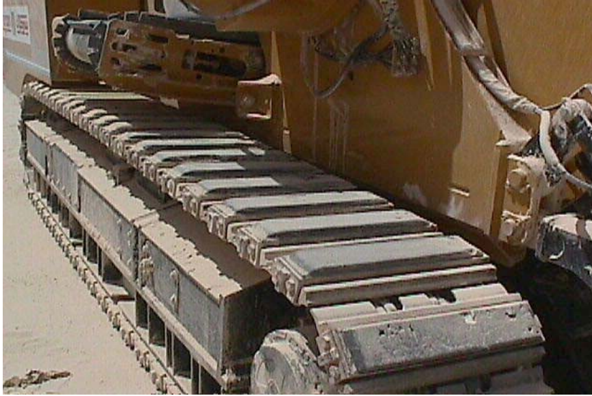
شكل (٥-٤٩): التغطية المطاطية للجزير لحماية سطح الأسفلت
