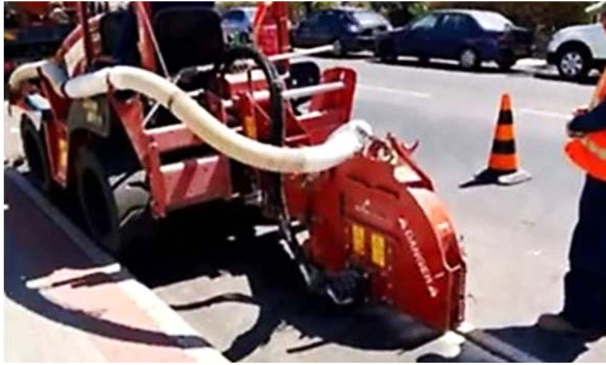
شكل (٥-٧): ماكينة قص وقطع الأسفلت وشفط ناتج الحفر
