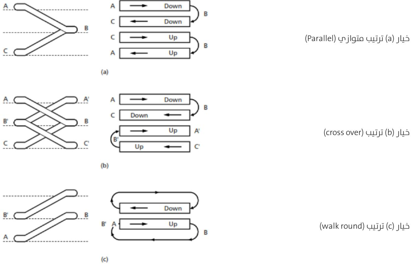
شكل رقم (3-1): يوضح خيارات الترتيب للسلاسل الكهربائية المتحركة
