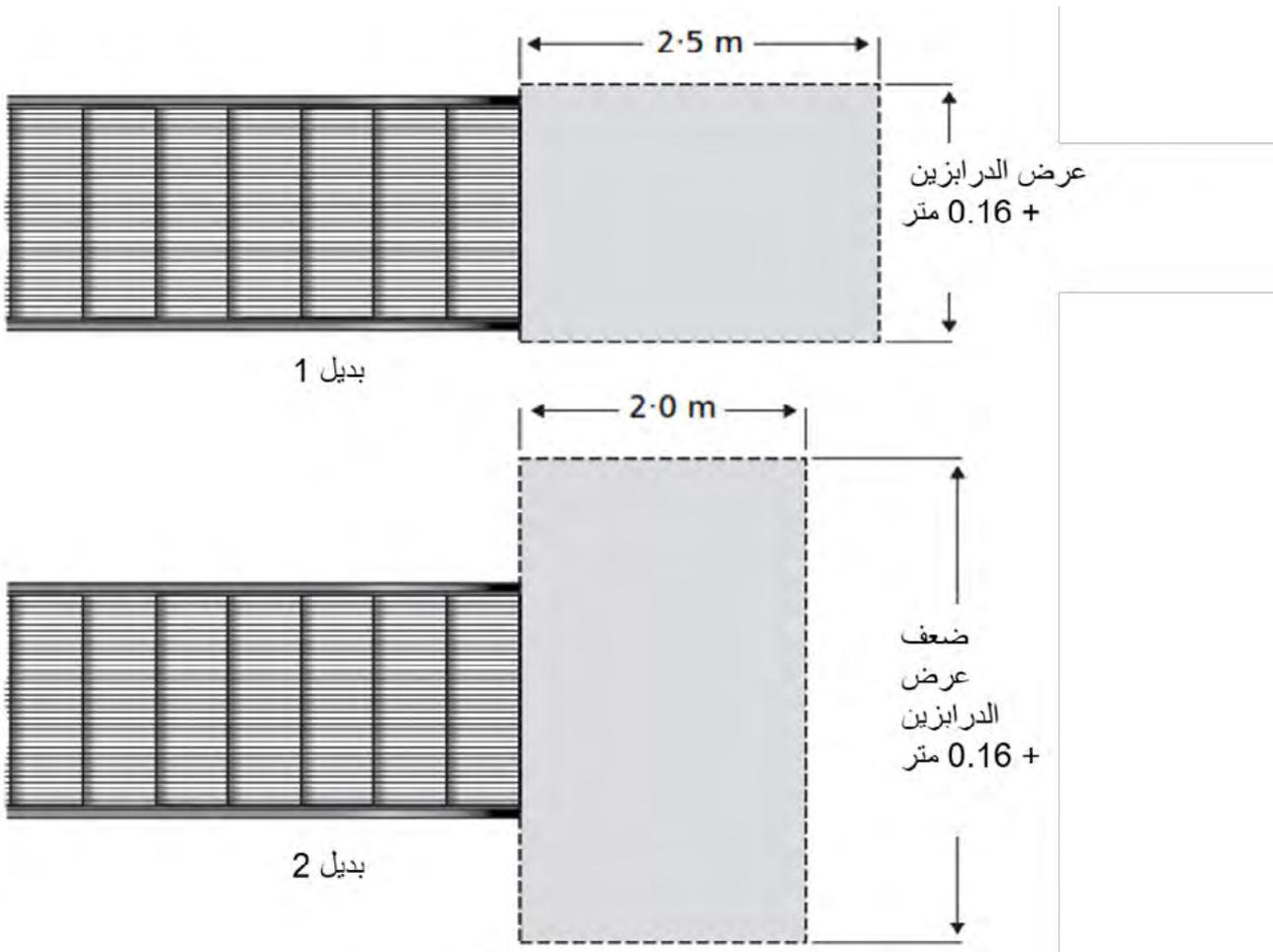
شكل رقم (2-1): يوضح خيارين لعمق الهبوط للسلالم والمشيات الكهربائية المتحركة (المرجع BS EN 115:1-2008 + 2010، A1: بعد الترجمة)
