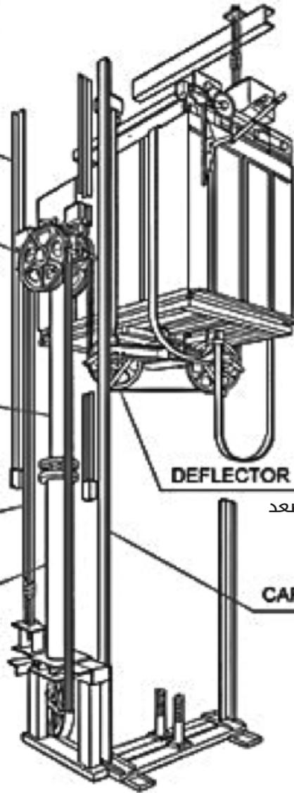
شكل رقم (10-1): مصعد هيدروليكي بنظام رفع غير مباشر Indirect Acting Hydraulic Lift
