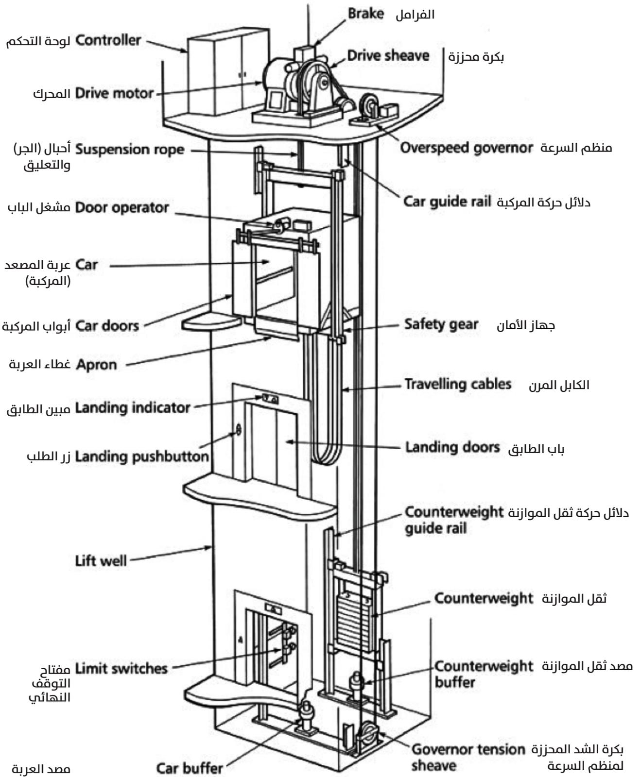
شكل رقم (7-1): مصعد جر كهربائي بغرفة ماكينات منفصلة أعلى البئر MR Lift Electric Traction Machine Room
