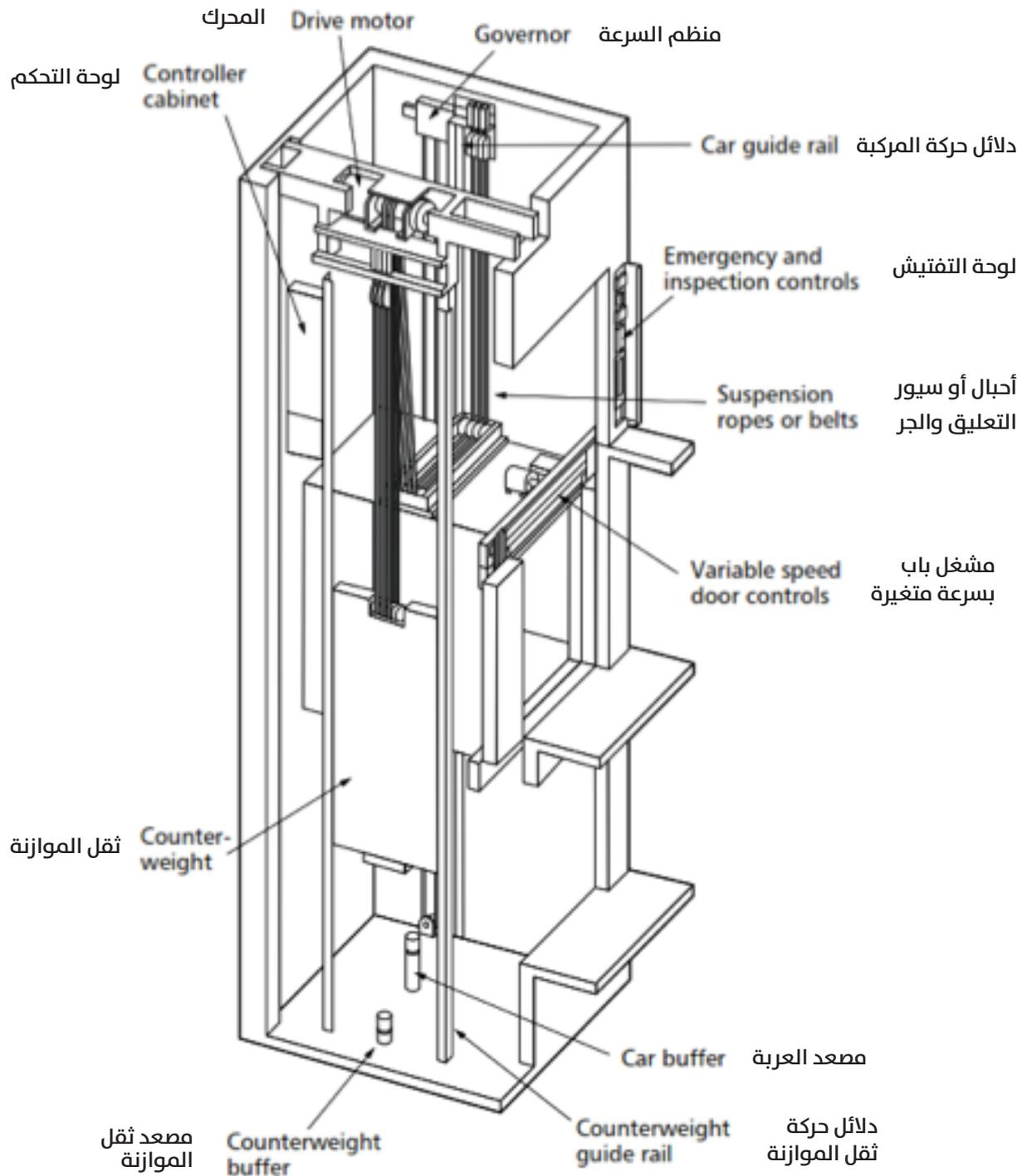
شكل رقم (8-1) : مصعد جر كهربائي بدون غرفة ماكينات Electric Traction Machine Room-Less MRL Lift
