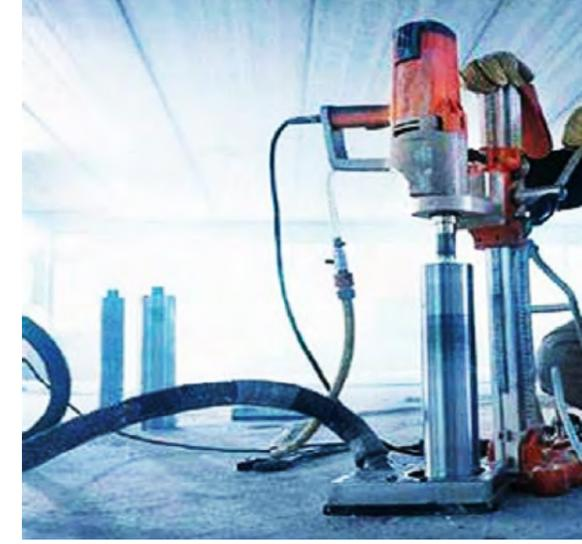
شكل (12) شكل نمطي لماكينة اختبار القلب الخرساني في اختبار لسقف
