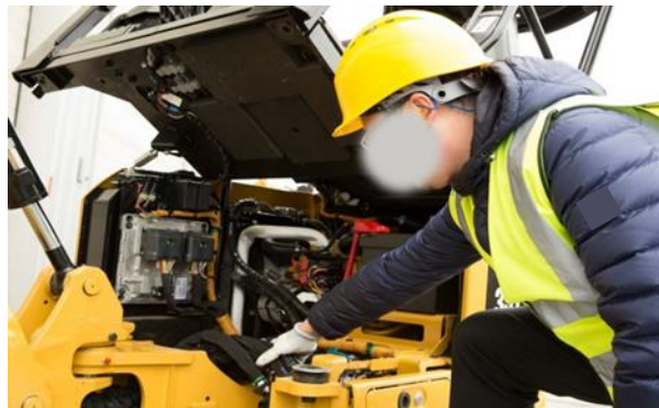
شكل رقم 10: معدات السلامة (خوذة وقفازات) لصيانة الجرافات
