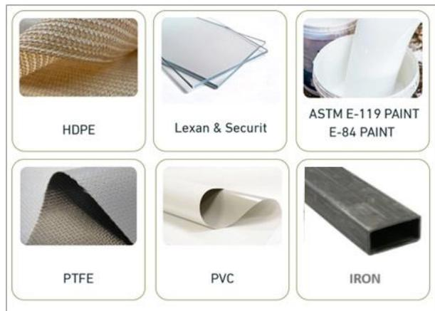
شكل رقم (١١): المواد المسموح استخدامها لإنشاء المظلات
