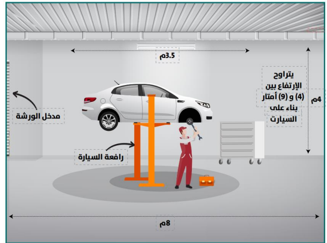
شكل توضيحي (3): رسم توضيحي جانبي وعلوي لقياسات قسم صيانة السيارات
