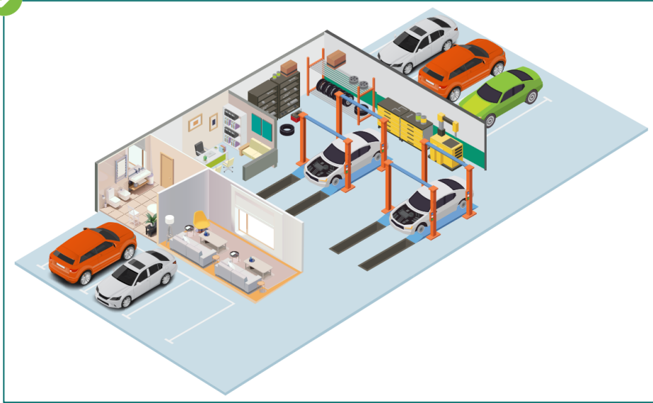
شكل توضيحي (2): نموذج استرشادي لورث إصلاح المركبات الخفيفة (السيارات)
