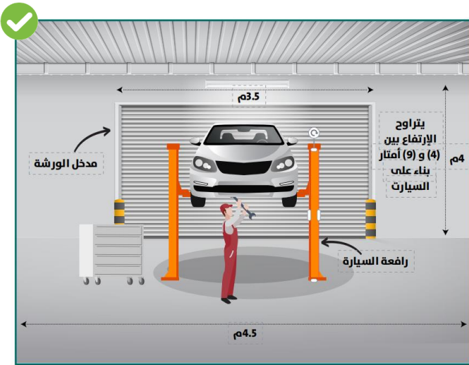
شكل توضيحي (3): رسم توضيحي جانبي وعلوي لقياسات قسم صيانة السيارات
