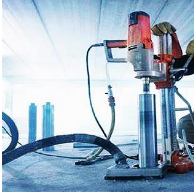
شكل رقم (12): شكل نمطي لماكينة اختبار القلب الخرساني في اختبار لسقف
